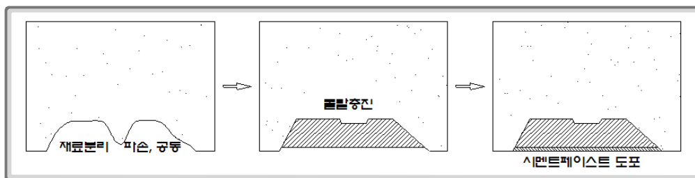
〈그림 8.4〉 단면보수(철근비노출부) 공법 개요도
